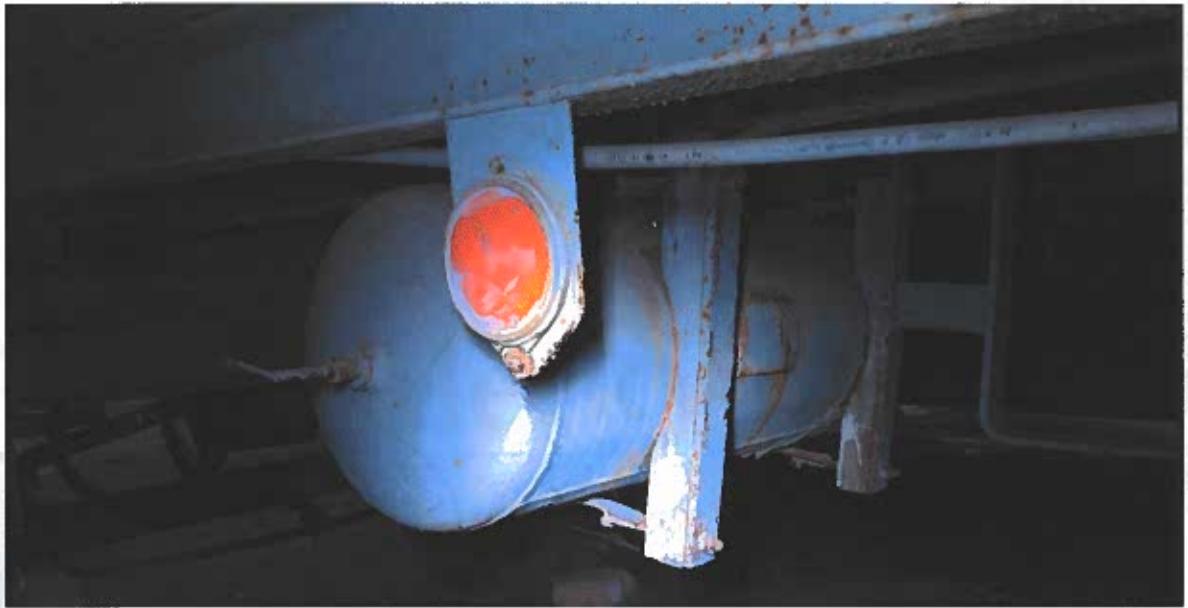
detail rámu a vzdušníkú na hodnoceném přívěsu
