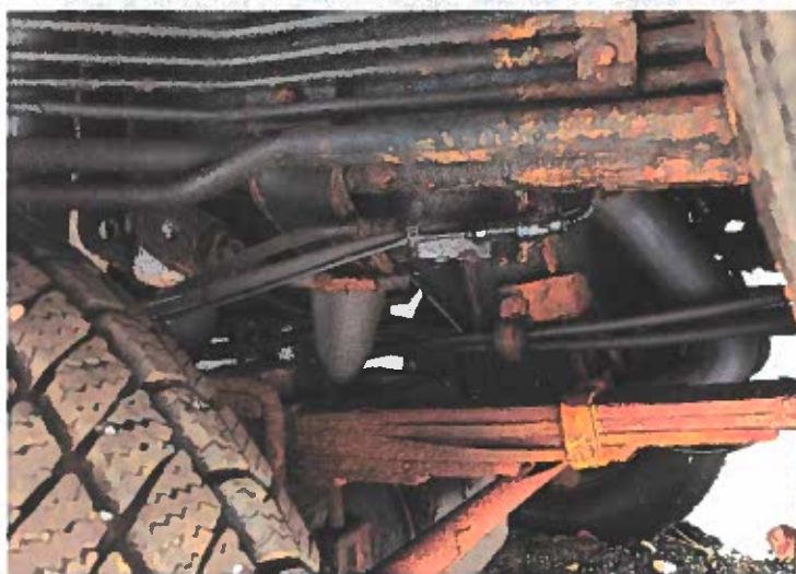
koroze podvozkových skupin
