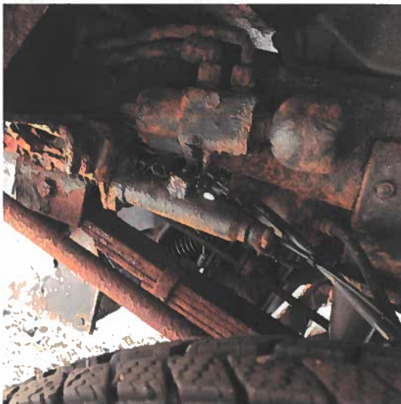
korozie podvozkových skupin
